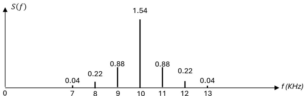
8. Pour obtenir un indice de modulation 10 fois plus grand, on utilise un multiplicateur de fréquence qui multiplie la fréquence  $s(t)$  par 10, ce qui revient à multiplier l'indice de modulation de signal par 10.
